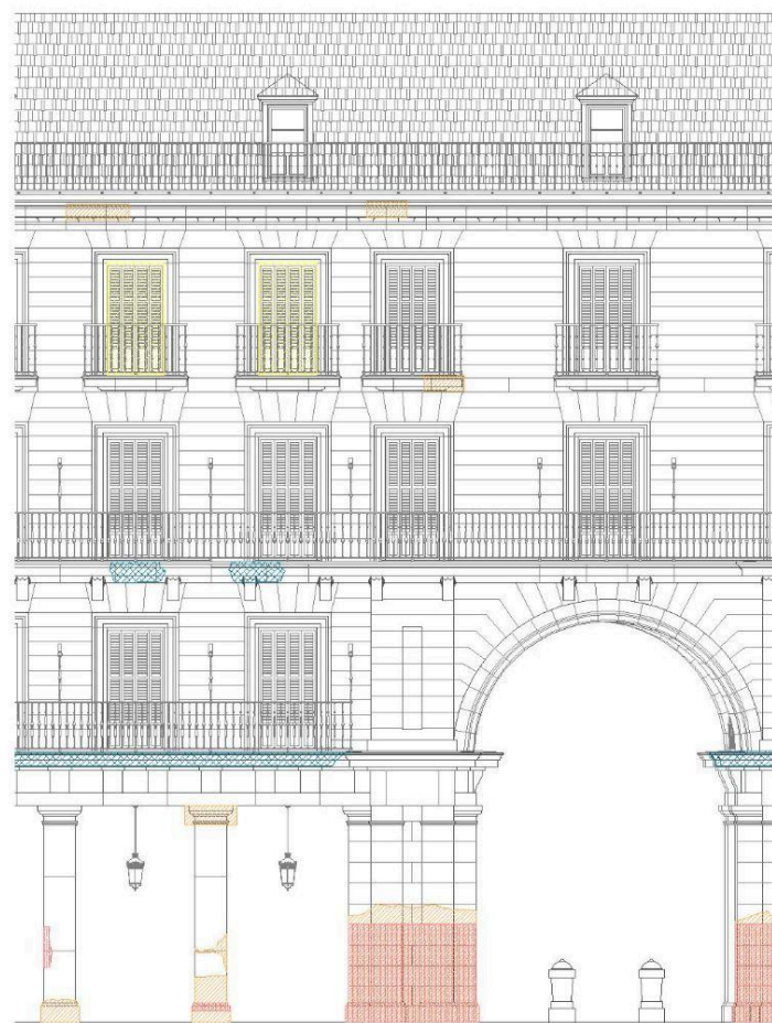
Análisis de daños en Fachadas de la Plaza Mayor
