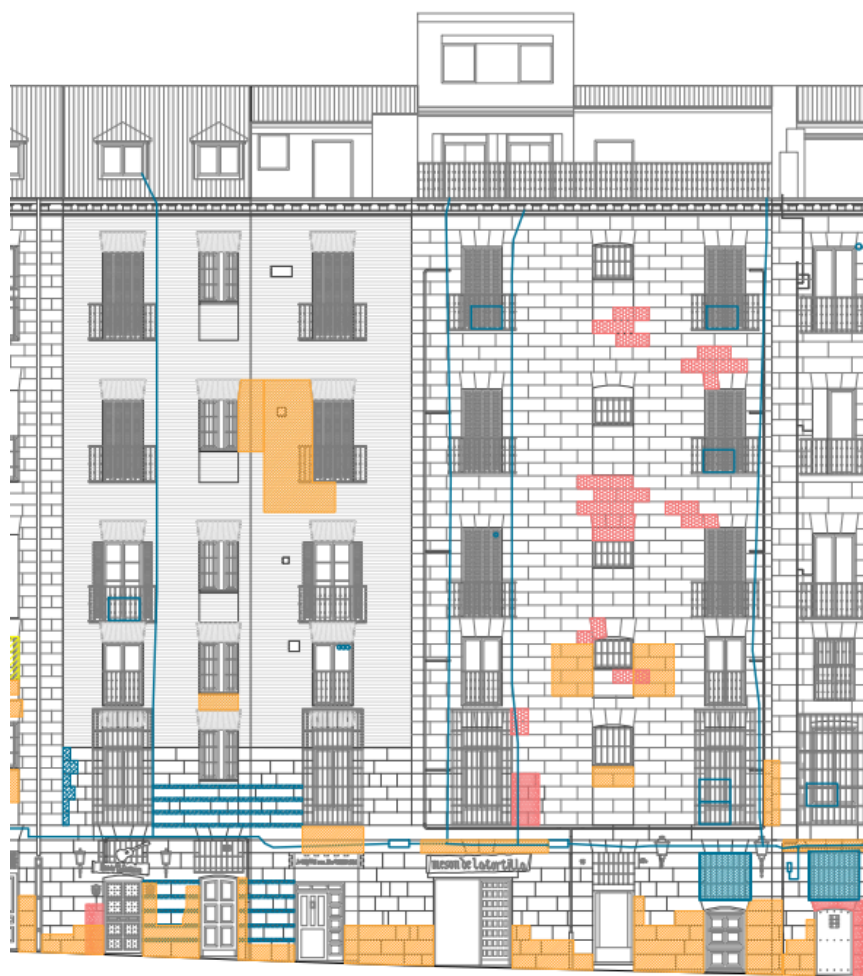
Análisis de daños en Cava de San Miguel
